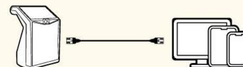
GTRAKとPC/モバイルデバイスを直接LANケーブルで接続します。
